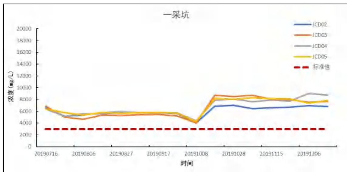
图 5.3.19 一采坑水质监测点矿化度监测值
