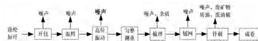
图 2-3 针刺生产线 2# 工艺流程图
