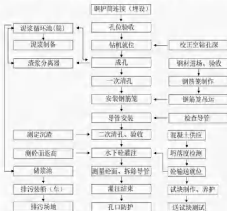
图 4-1 钻孔灌注桩施工工艺图
