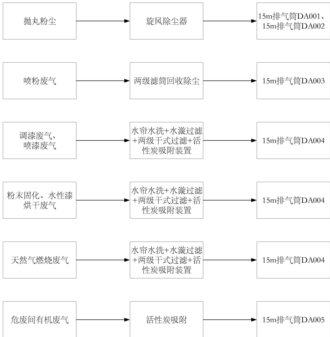
图 3-3 项目废气处理工艺流程图
