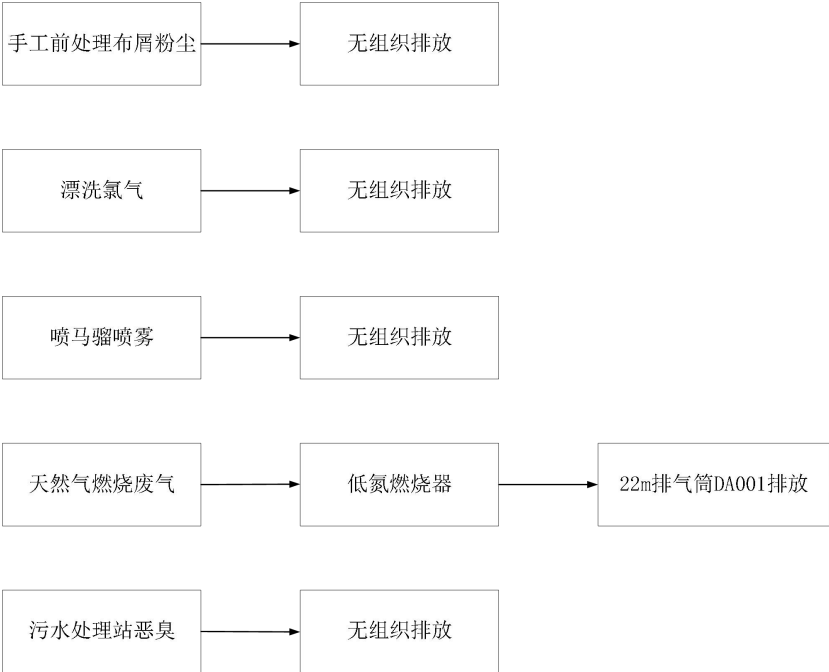
图 3-3 项目废气处理流程图
